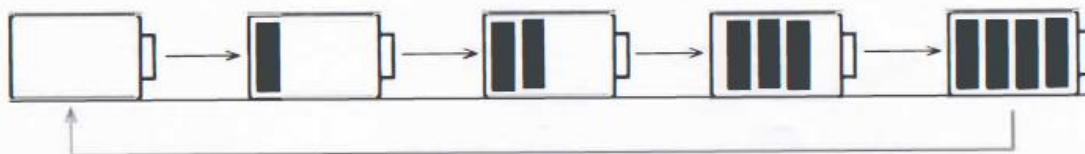
BAT<3.80V时依次循环步进亮灭示意图
