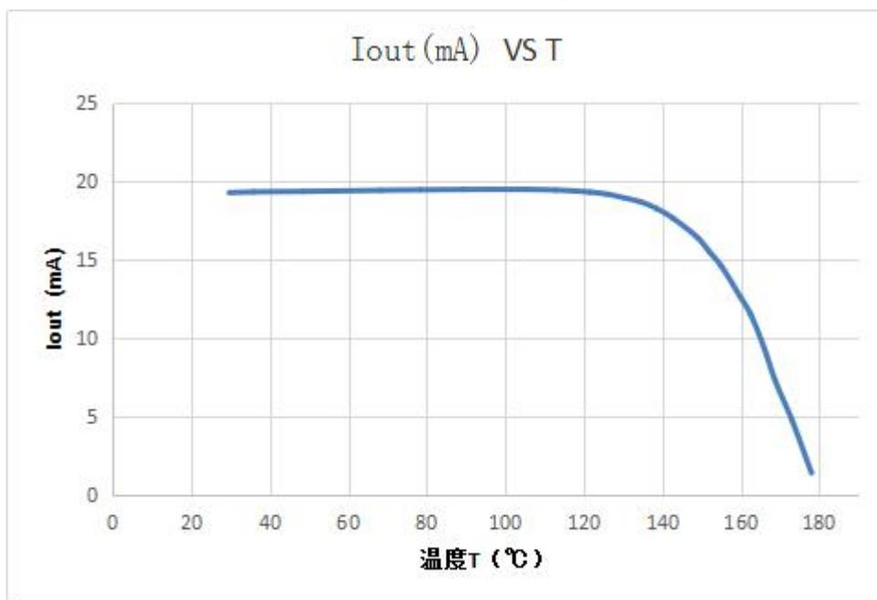
输出电流温度特性 ( $I_{OUT} = 20mA$ )
