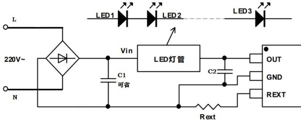
图 2 典型应用电路—交流电源输入
