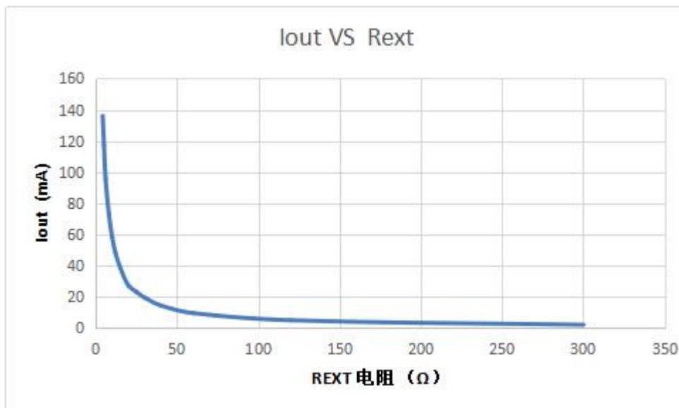
输出电流与 REXT 电阻关系曲线（测试条件：V<sub>OUT-GND</sub>=30V）
