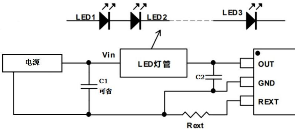
注：图中“电源”可以是普通直流电源，也可以为脉动直流电源
