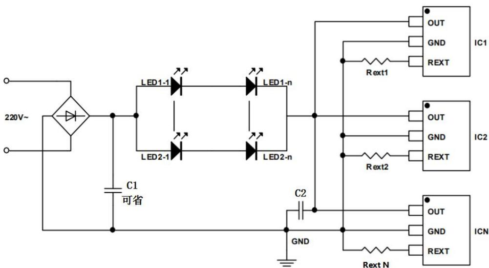
图 3 并联应用电路原理图
