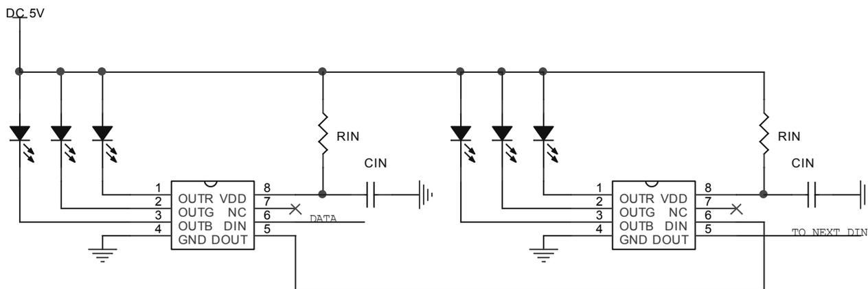
1、TC2811Z 典型应用电路参数包含电源输入电压  $V_{IN}$ , 芯片 VDD 电容  $C_{IN}$ 。 $C_{IN}$  建议 0.1 $\mu$ F 或以上。 $R_{IN}$  根据输入电压来取值。
