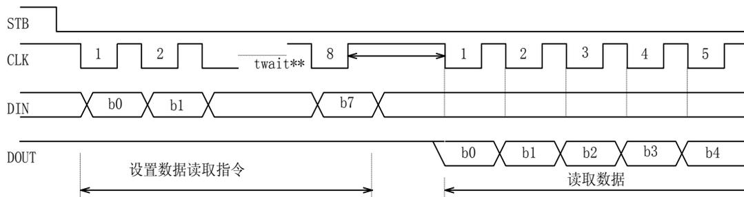
因为 DOUT 管脚为 N 管开漏输出，所以该脚要连接一个外部上拉电阻 (1KΩ 到 10KΩ)
