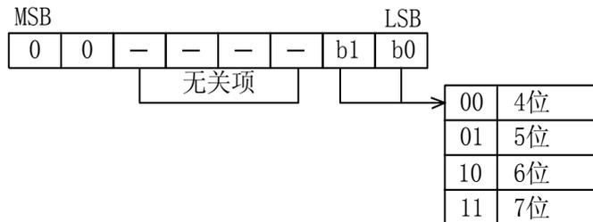
该指令用来设置选择段和位的个数 (4~7 位, 8~5 段)。当指令执行时, 显示被强制终止, 同时键扫描也停止。要重新显示, 显示开/关指令“ON”必需被执行, 但当相同模式被设置时, 则上述情况并不发生。上电时, 设置模式为 4 位, 8 段。
